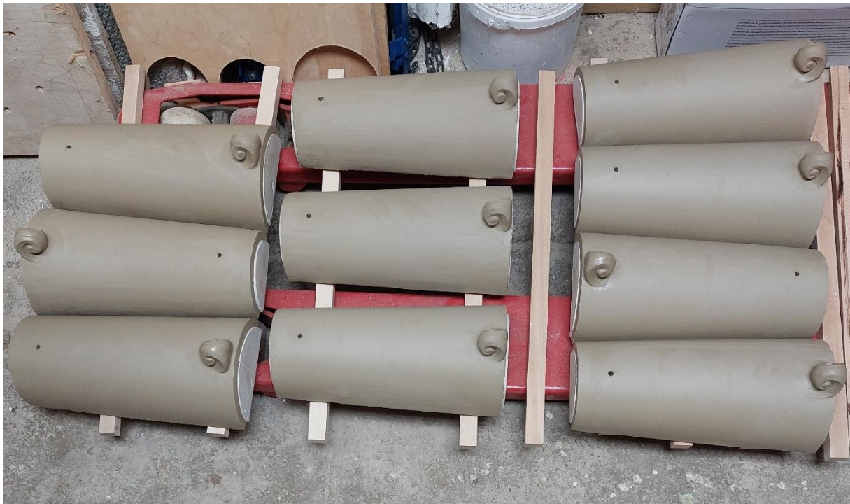
Finálne hřebenáče po nasadení na sadrové negatívy. Proces sušenia na sadrových negatívoch trval 5 dní.
