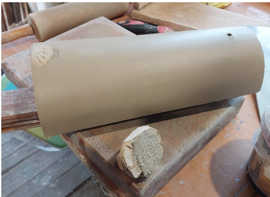
Telo hrebenáča po vyvalcovaní hliny a nasadení na sadrové kopyto a orezaní.
