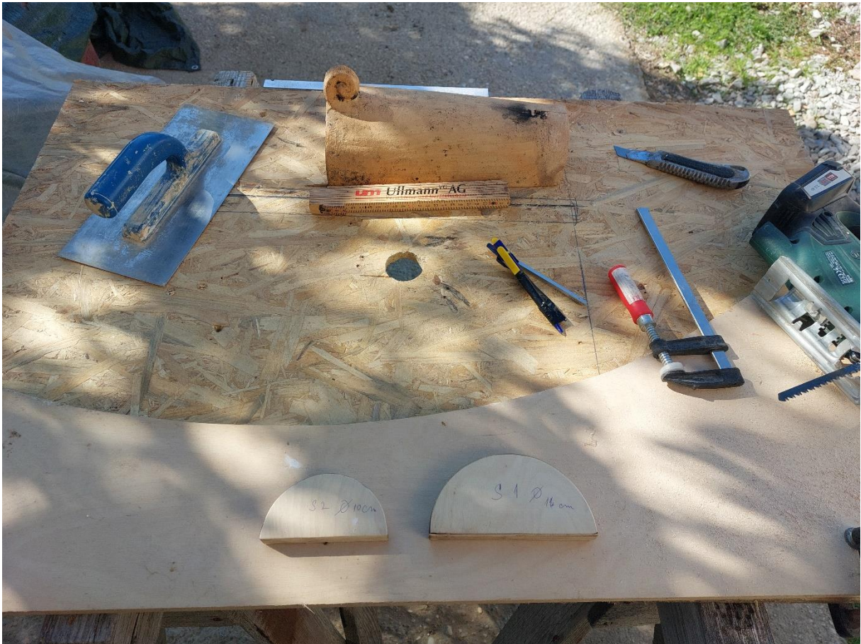
Príprava šablón na vytiahnutie negatívu sadrového kopyta
