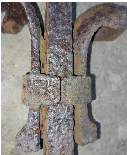
Poškodenia kríža spôsobené koróziou materiálu.
