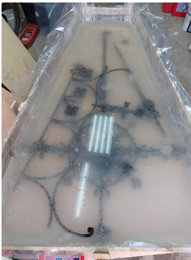
Odhrdzovanie kovového materiálu
