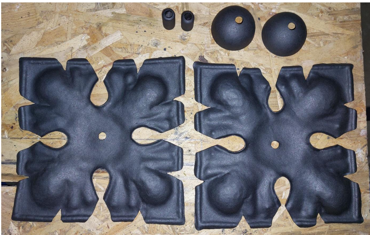
Stav po roznitovaní ornamentu kvetu kríža. Tepanie ornamentu s plechového materiálu do asfaltu. Na spodnej fotografii nastriekané komponenty pripravené na nitovanie.
