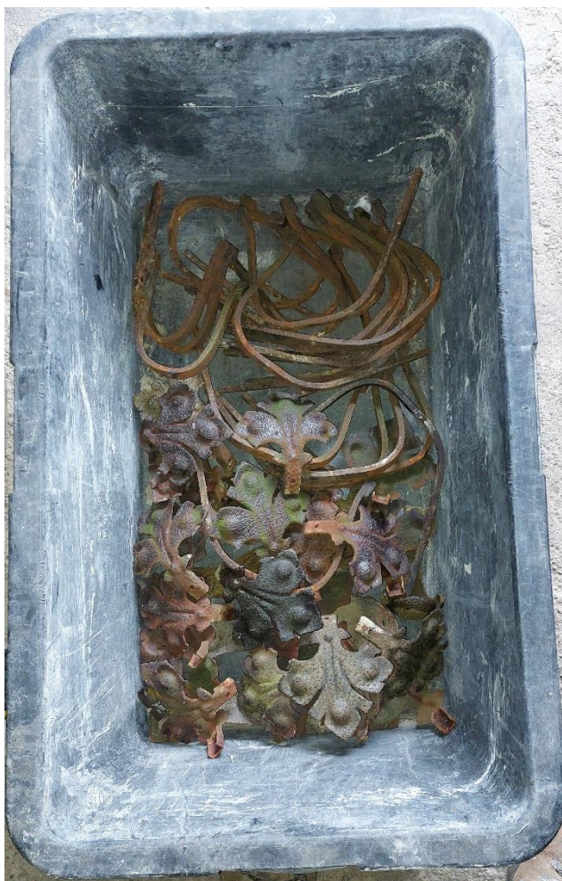
Predmety obnovy zaliate v roztoku hydroxidu sodného.
