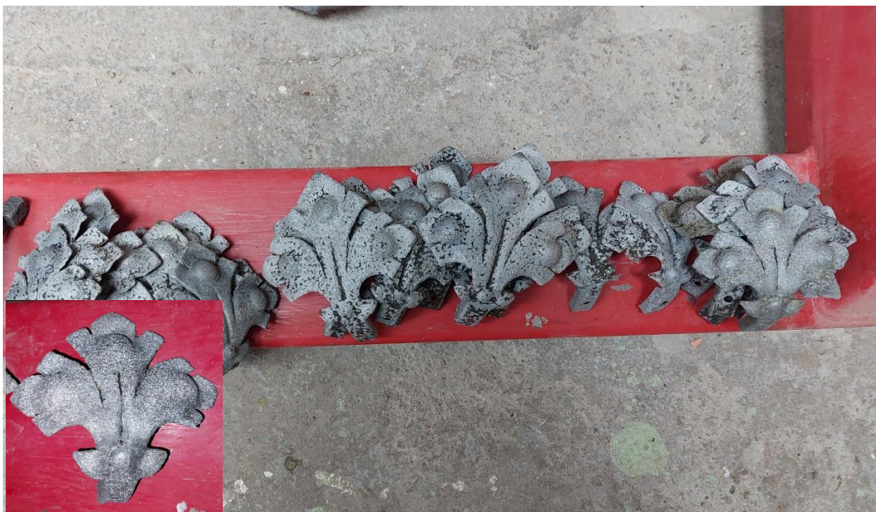
Na fotografii vidíme odhrdzané ornamenty listov. Predmety boli po čistení hrdze zbavené hnedých oxidov hrdze. Na povrchu vidíme tmavé oxidy, ktoré sú súčasťou kovu.
