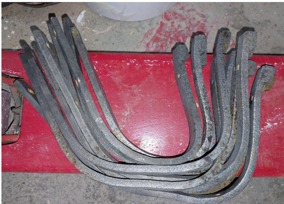
Stav po odhrdzení hákov v kyseline fosforečnej
