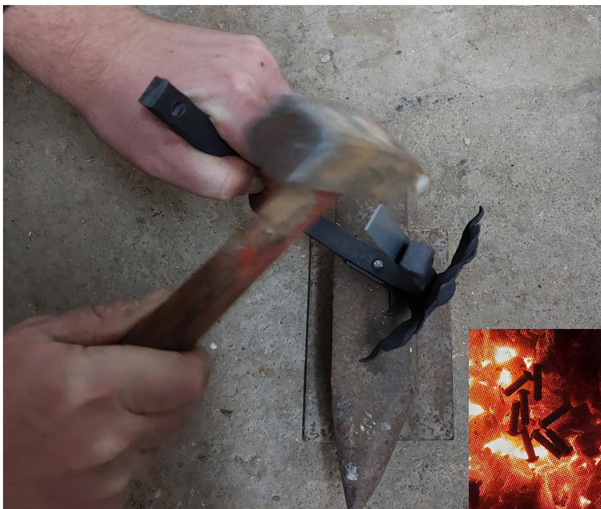
Nitovanie ornamentu listu pomocou nahriateho rozklepávacieho nitu. Kovové niti boli nahriate v žeravom EKO hrášku.
