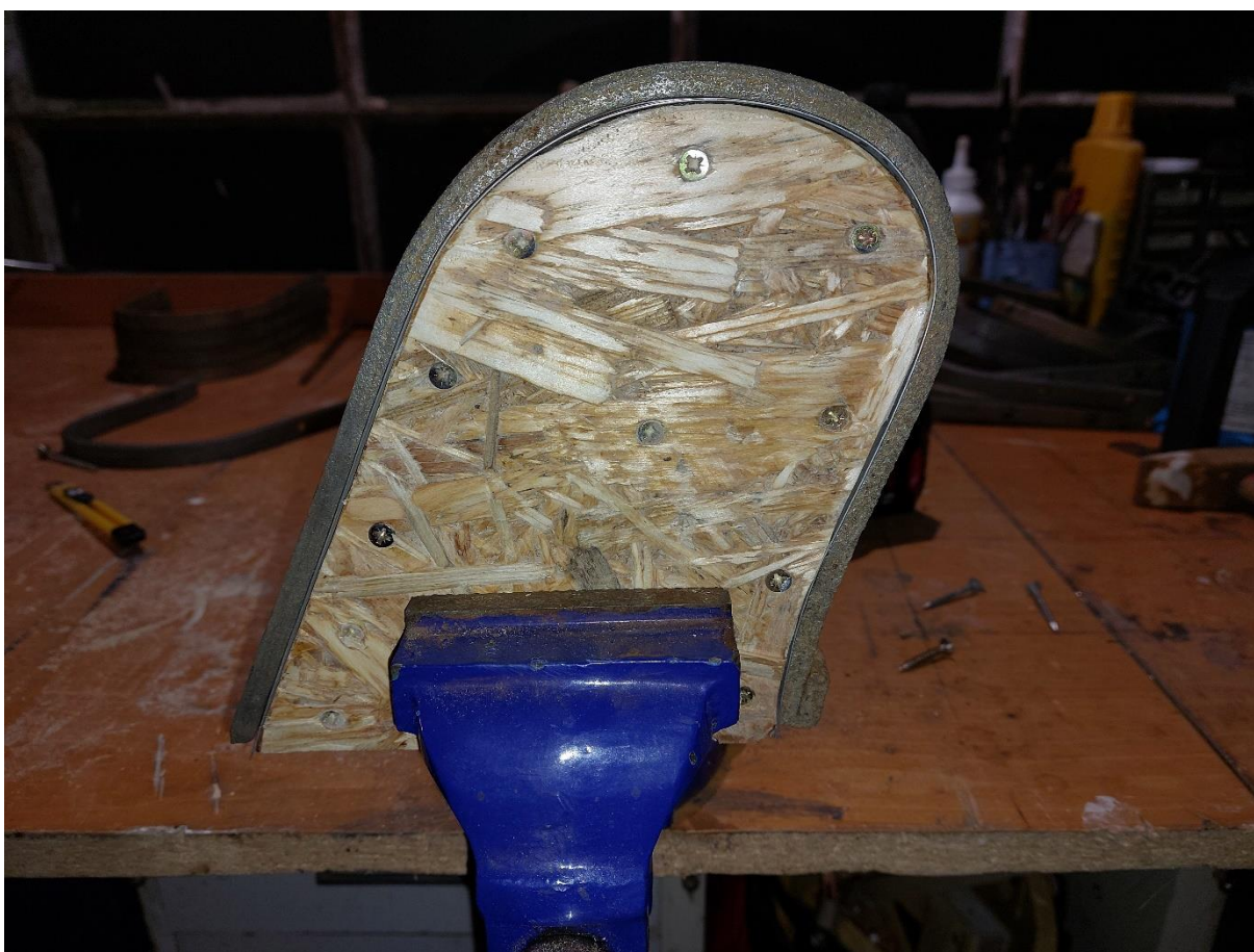
Výroba oplechovanej drevenej formy podľa originálneho tvaru žľabového háku
