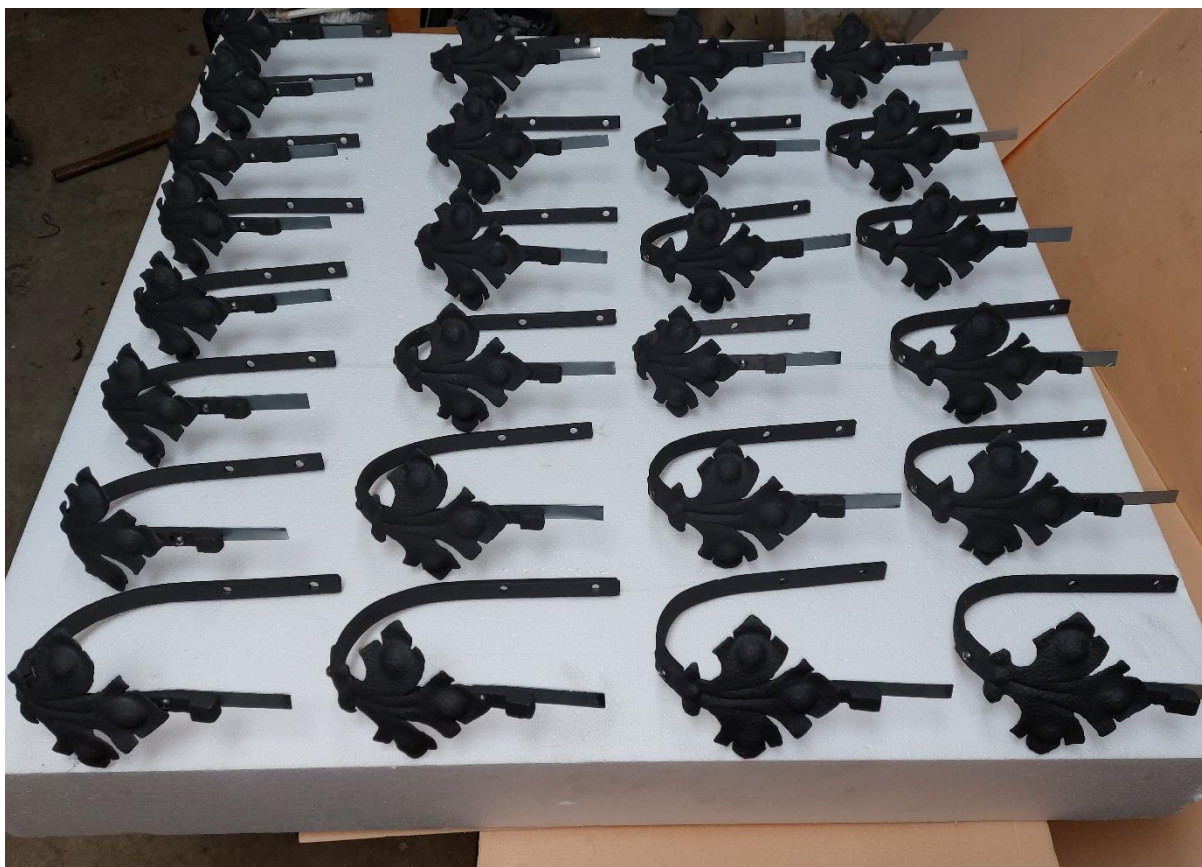
Fotografia stavu hákov po znitování
