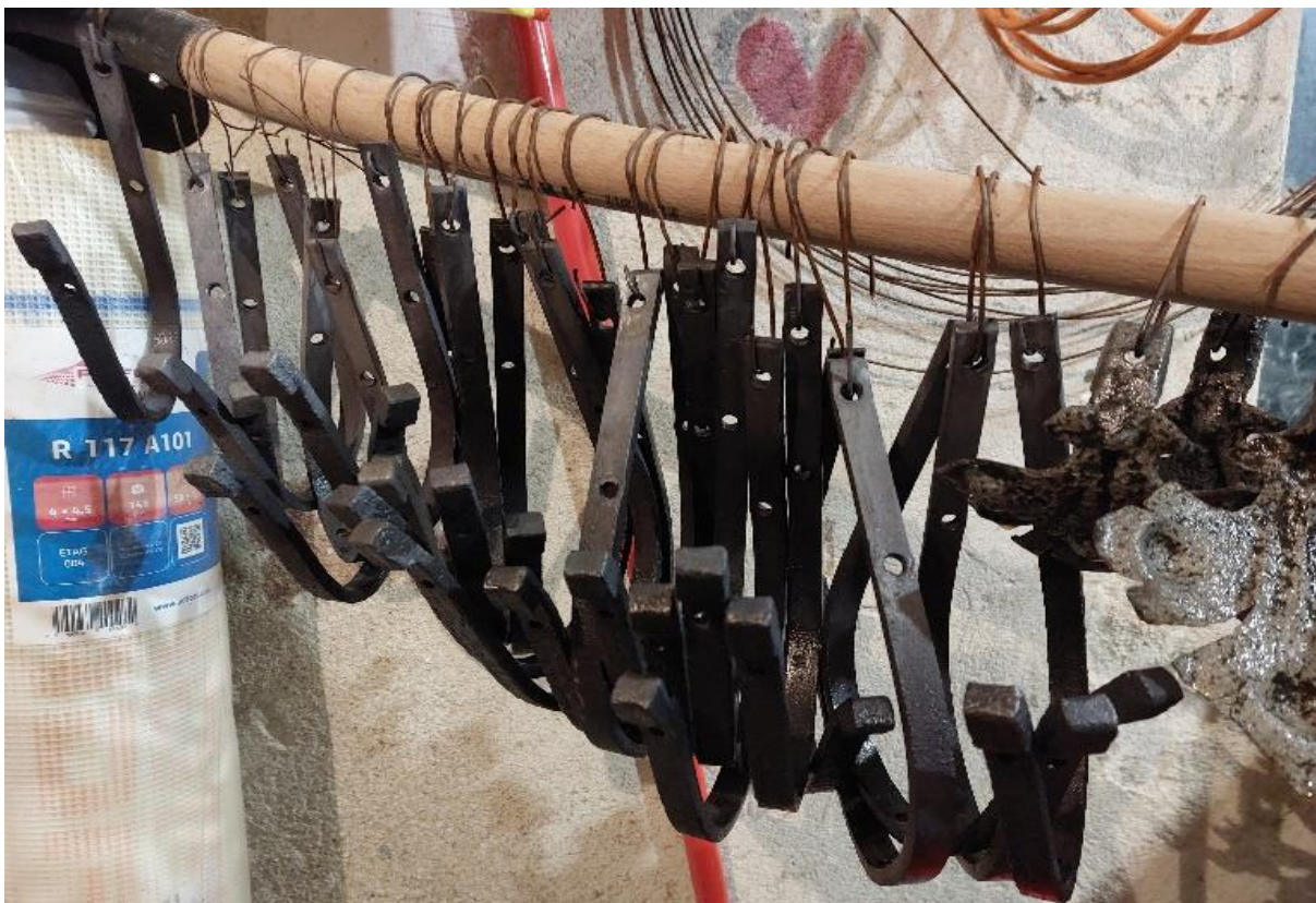
Konzervovanie predmetov obnovy pasivátorom s tanínom od firmy WORKO.
